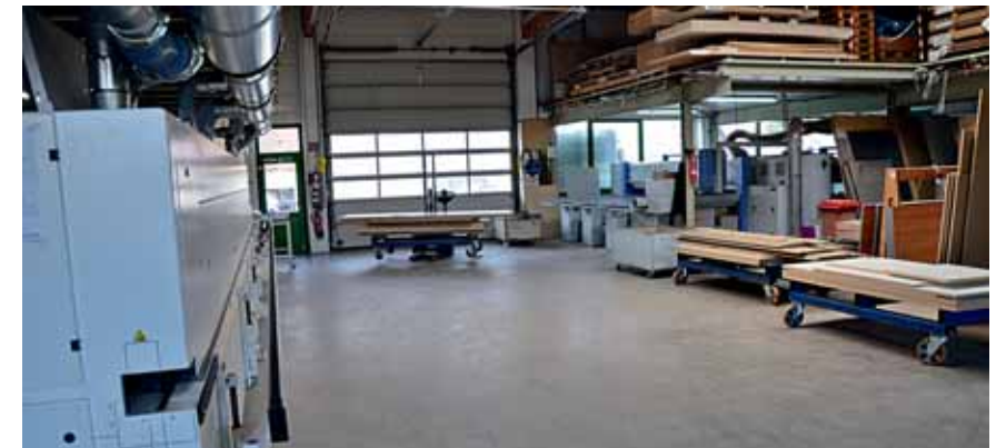
Der „Tanzsaal“ zwischen der Zuschnittsäge „HPL 380“ von Holzma (hinten rechts, heute „Homag Sawteq B-300“) und der „Edgeteq S-500“ (vorne links)
