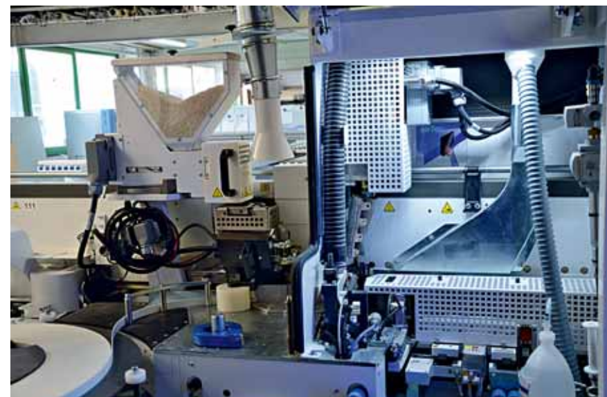
Das Herz der „Edgeteq S-500“ bilden die beiden Kantenanleimverfahren mit PU-Aggregat (links) und „Air-Tec“ (rechts)
