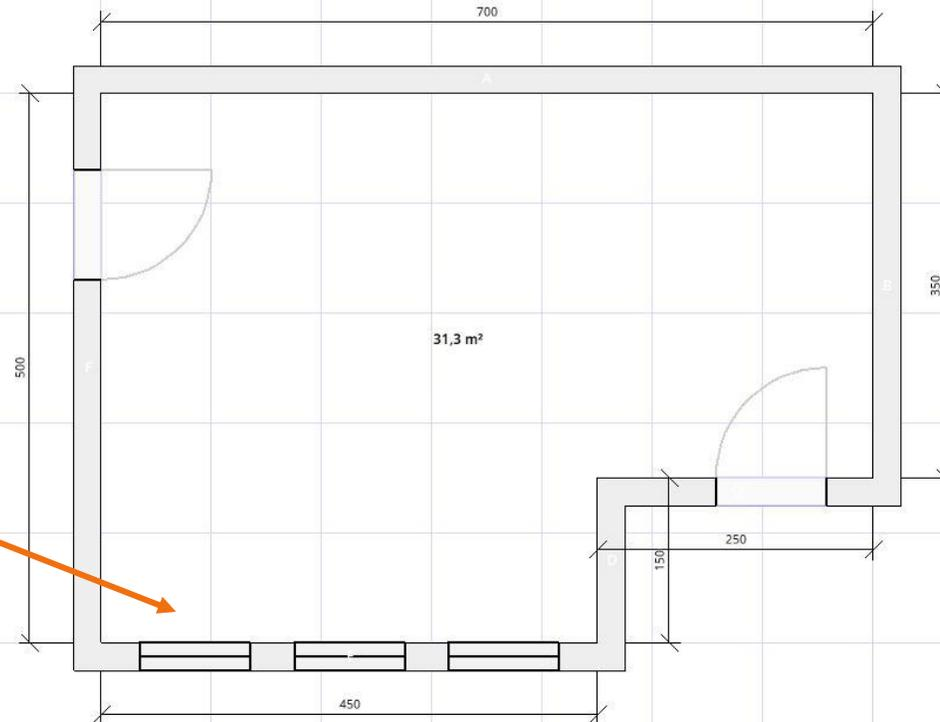
Durch Doppelklick auf die Maßzahlen kann die Position genauer angegeben werden. Durch Doppelklick auf das Objekt können dessen Maße angepasst werden.
